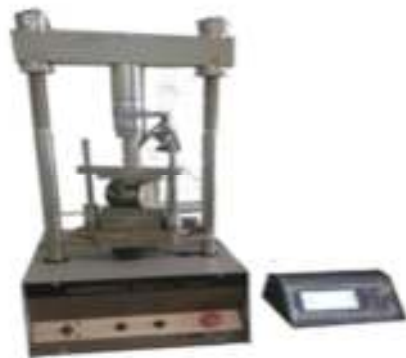
شکل ۳. فک دستگاه UTM5 مربوط به آزمایش مدول برجهندگی
