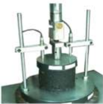
شکل ۵. فک دستگاه UTM5 مربوط به آزمایش خزش
